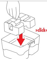
**Setzen Sie den Nasssaug-Einsatz von oben in den Schmutzwasserbehälter ein.**
