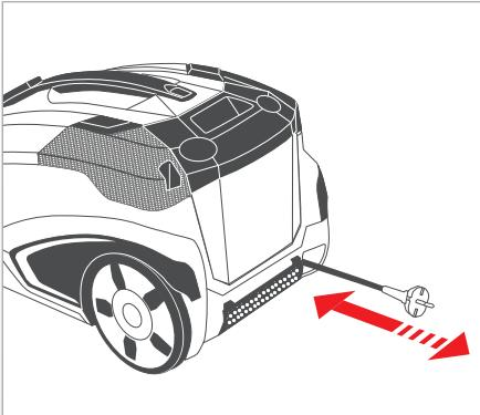
Ziehen Sie den Netzstecker aus der Steckdose. Ziehen Sie das Netzzanschlusskabel mit leichtem Zug vom Gerät weg und lassen Sie es los. Das Kabel rollt sich dann automatisch auf.
