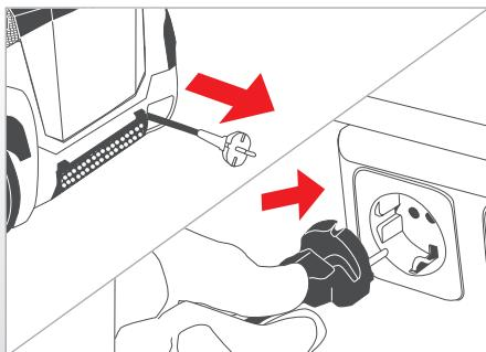
Greifen Sie das Netzzuschlusskabel am Netzstecker. Ziehen Sie das Netzzuschlusskabel auf die gewünschte Länge heraus. Stecken Sie den Netzstecker in die Steckdose.
