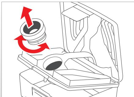
**Bei starker Verschmutzung kann der sogenannte Ejektor durch Drehen der Stutzendichtung für die Reinigung entnommen werden.**
