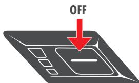
Zum Ausschalten des Gerätes drücken Sie die Starttaste etwas länger. Beim Wiedereinschalten startet das Gerät in der zuvor gewählten Saugleistungsstufe, sofern es nicht vom Stromnetz getrennt wurde.
