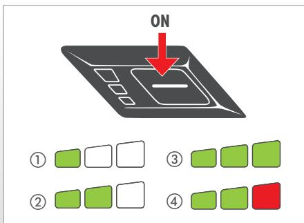
Schalten Sie das Gerät durch Drücken der Starttaste am Gerät ein. Das Gerät startet im Eco-Modus, was durch das Leuchten von zwei grünen Anzeigebalken angezeigt wird. Durch kurzes Drücken der Starttaste können weitere Saugleistungsstufen gewählt werden. Folgende Saugleistungsstufen sind möglich:
