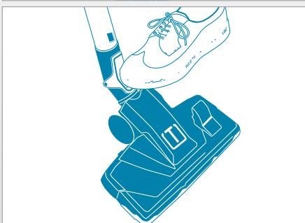
**ⓘ** Nicht alle Bodendüsen verfügen über eine Verriegelung.
